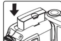
要取出锂电池，按箭头方向拨动电池锁定杆，锂电池将自动弹出。
