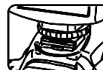
要取下闪光灯，请松开【固定旋钮】，然后将闪光灯从相机热靴中推出。
