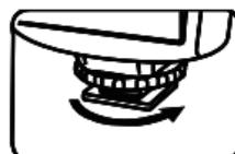
将闪光灯【热靴座】完全推入相机热靴。
