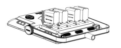
2、拆卸锂电池时,请先按下电池锁扣再取出锂电池
